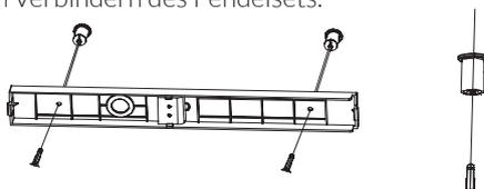
2. Bitte stellen Sie sicher, dass sich das Seil über dem runden Loch des Steckers befindet und passen Sie die Seillänge an, bevor Sie die Schraube festziehen.
