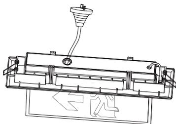
4. Falten Sie die Feder um das Schild in der Decke einzuklicken. Installation abgeschlossen.
