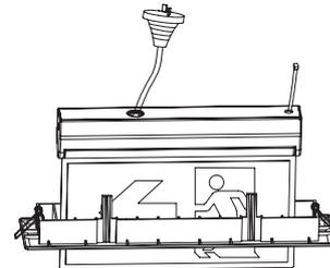
3. Stecken Sie das andere Ende des Anschlusskabels in die Steuerplatine an der vertieften Halterung.
