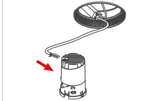
9 Lampenkörper in den Montagering einsetzen. Die Kunststoffklammer in den Montagering einrasten.
