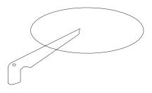
3. Halten Sie den Federclip zurück und schieben Sie das Downlight in das Loch.
