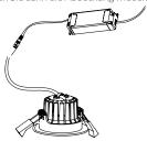
4. Stellen Sie sicher, dass das Downlight fest in der Decke befestigt ist; schalten Sie danach die Stromversorgung ein
