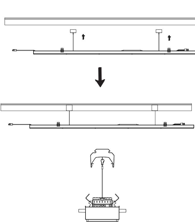
4. Gemäss Anschluss-Schema anschliessen und die Leuchteneinsätze mit den entsprechenden Wago-Klemmen miteinander verbinden.
