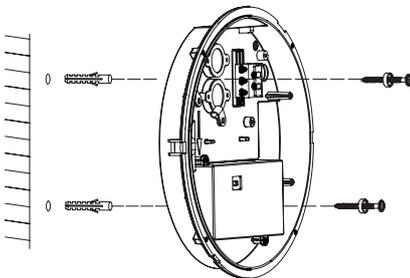
5. Schliessen Sie den Stecker an (mit Not: Stecker zwischen Batterie und Treiber verbinden), setzen Sie den Diffusor wieder auf das Rückgehäuse und befestigen Sie es mit Schrauben
