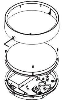
4. Definieren Sie die gewünschte Lichtfarbe via DIP-Schalter und verbinden Sie die Kabel mit der Anschlussklemme.
