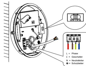
6. Befestigen Sie den Rahmen mit geeigneten Werkzeugen am Rückgehäuse
