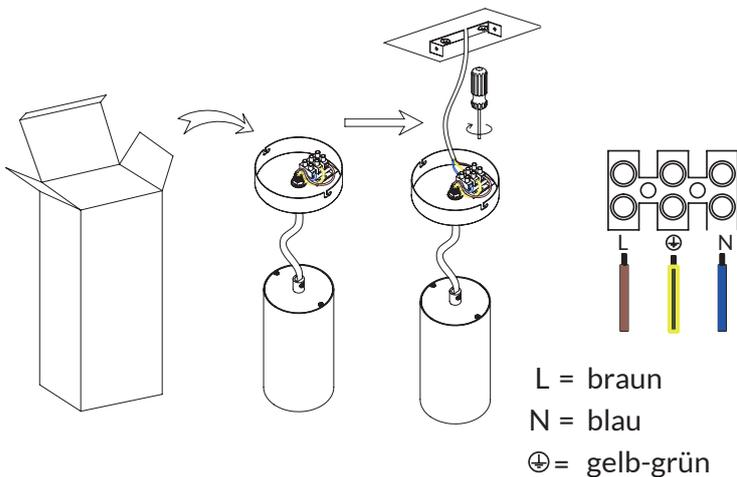
4. Richten Sie die Montagelöcher korrekt zwischen Rückplatte und Montagehalterung aus. Verschiessen Sie sie dann mit einer Schraube.
