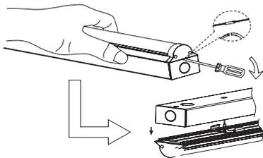
3. Aluminiumgehäuse der Leuchte an die Wand oder Decke montieren.
