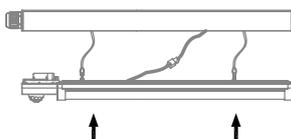
2. Öffnung für die benötigte Kabeleinführung heraus pressen.
