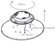
3. Setzen Sie die Wandmontagebox in das Loch in der Decke ein und befestigen Sie sie fest mit Schrauben.
