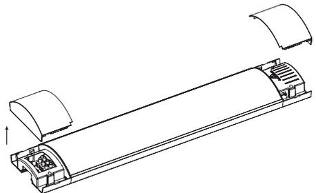
3. Befestigen Sie die Flatlite mit den dazugelieferten Schrauben direkt an der Wand.
