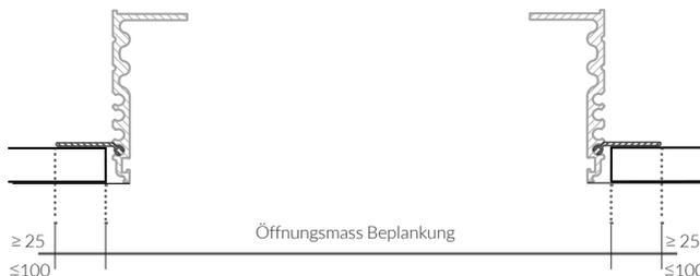
6. Einbauhilfe im Einbaurahmen platzieren und die Riegel vorschieben.
