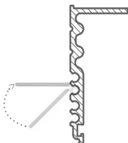
5. Einbaurahmen im Deckenausschnitt platzieren.
